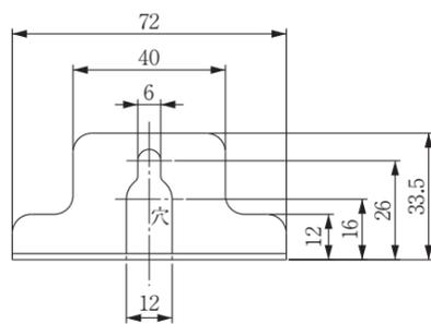
●取付金具下詳細図 (S=1/2) 左右共通
