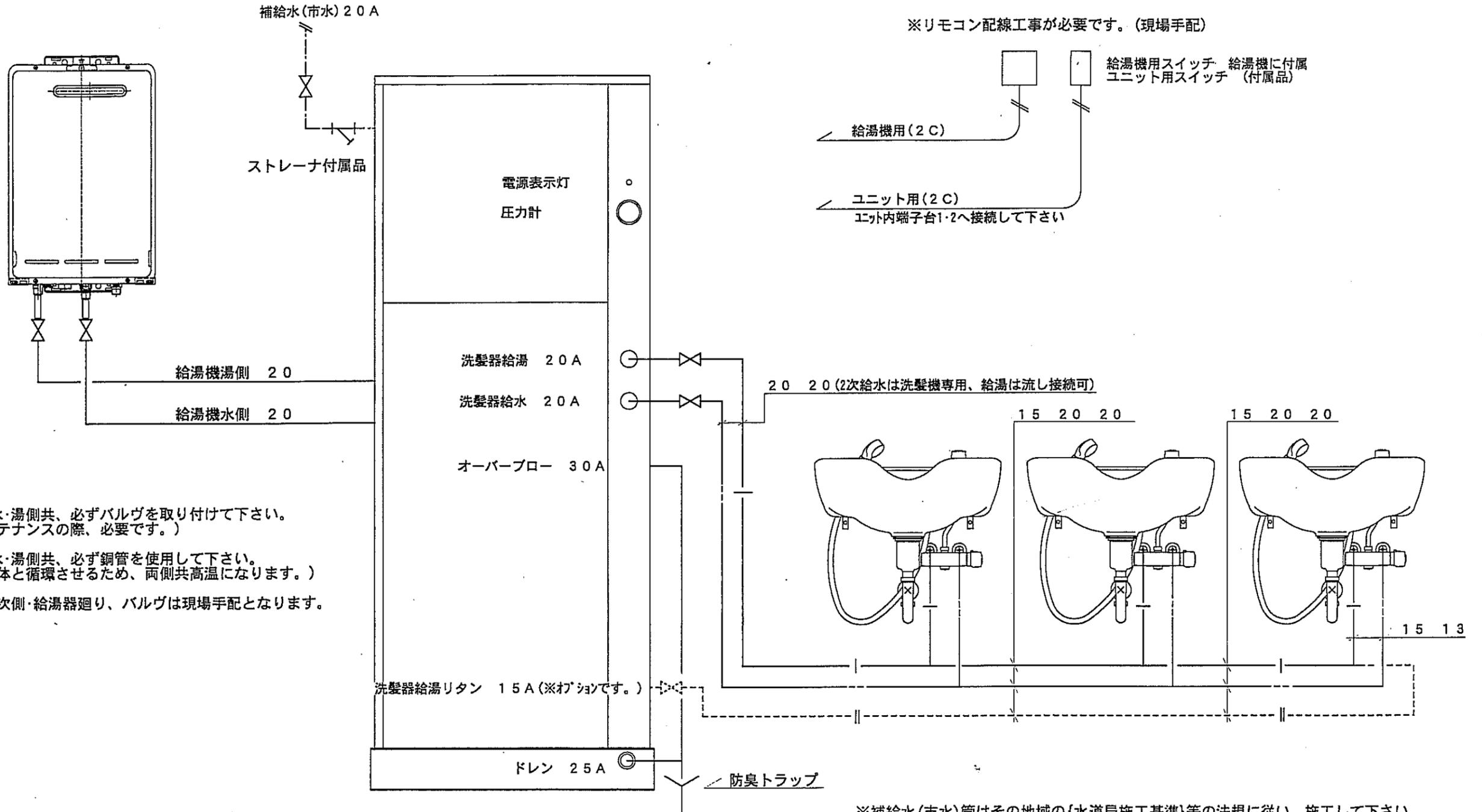
※給湯機 水・湯側共、必ずバルブを取り付けて下さい。
